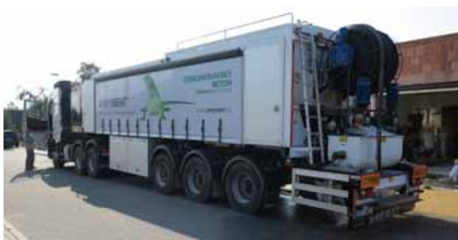
■ ANHYMENT® - mobilní výrobní zařízení na stavbě
