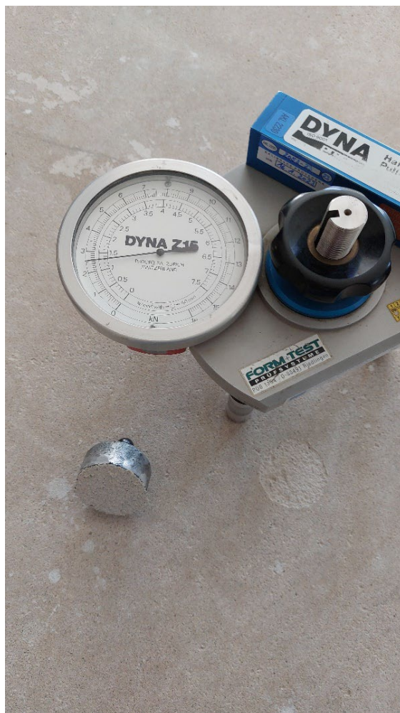
Obr. 2: Zkoušení pevnosti v tahu povrchových vrstev
