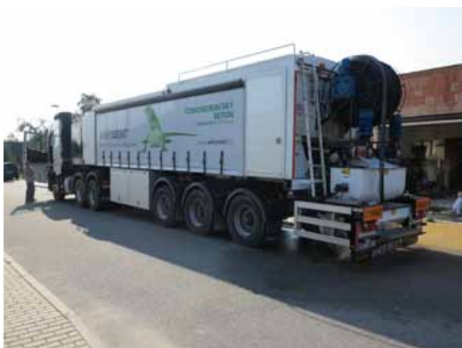
■ ANHYMENT® - mobilní výrobní zařízení na stavbě
