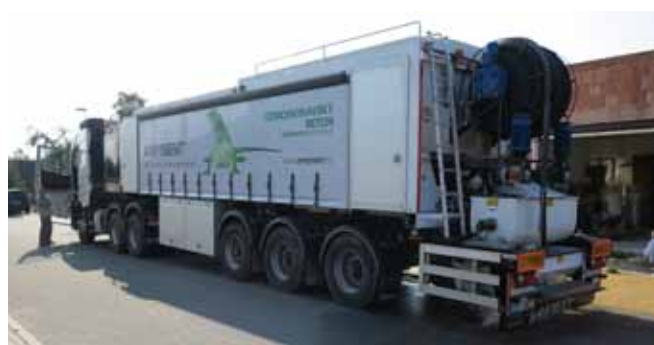
■ ANHYMENT® - mobilní výrobní zařízení na stavbě
