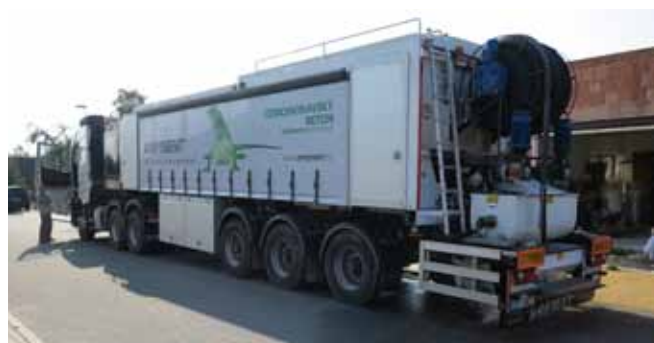
■ ANHYMENT® - mobilní výrobní zařízení na stavbě
