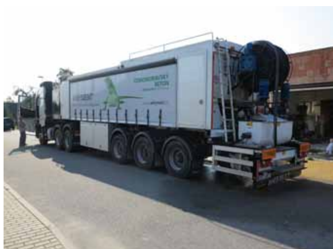
■ ANHYMENT® - mobilní výrobní zařízení na stavbě
