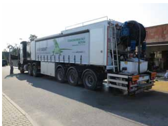
■ ANHYMENT® - mobilní výrobní zařízení na stavbě
