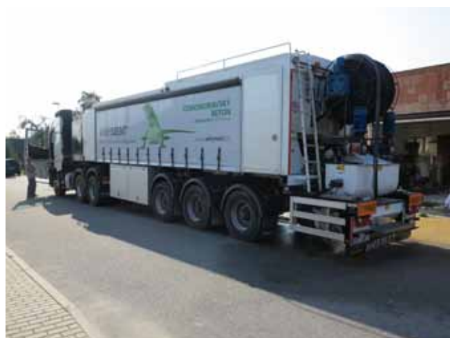
■ ANHYMENT® - mobilní výrobní zařízení na stavbě
