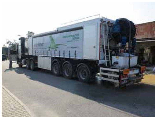
■ ANHYMENT® - mobilní výrobní zařízení na stavbě
