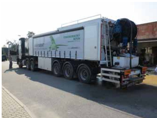
■ ANHYMENT® - mobilní výrobní zařízení na stavbě
