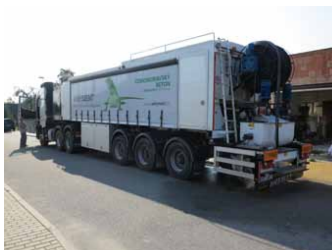
■ ANHYMENT® - mobilní výrobní zařízení na stavbě
